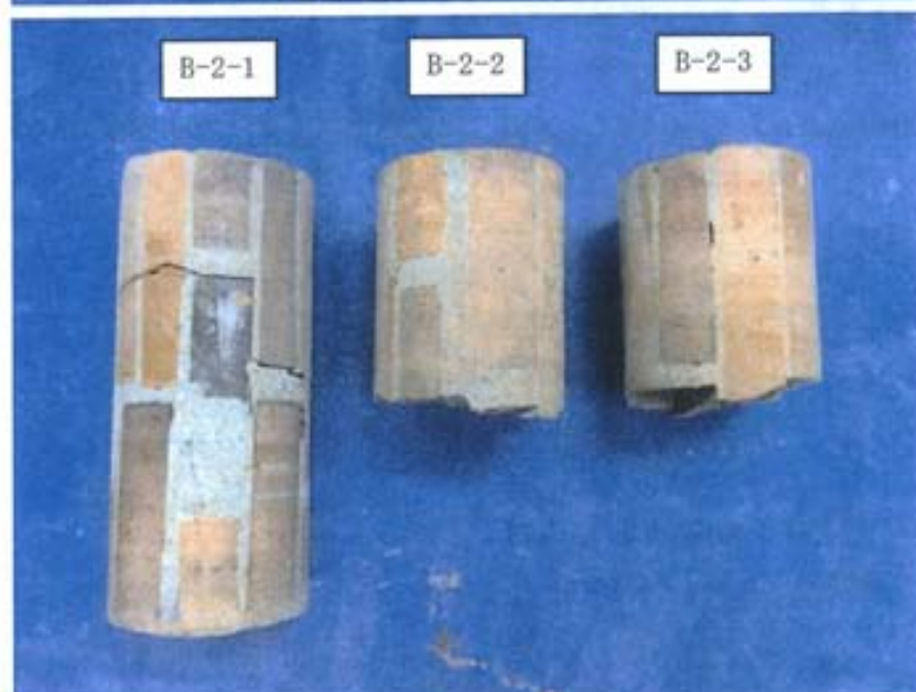
写真-13 供試体の外観 [れんがコア(要素)] (目地モルタルのせん断強度 試験用)
