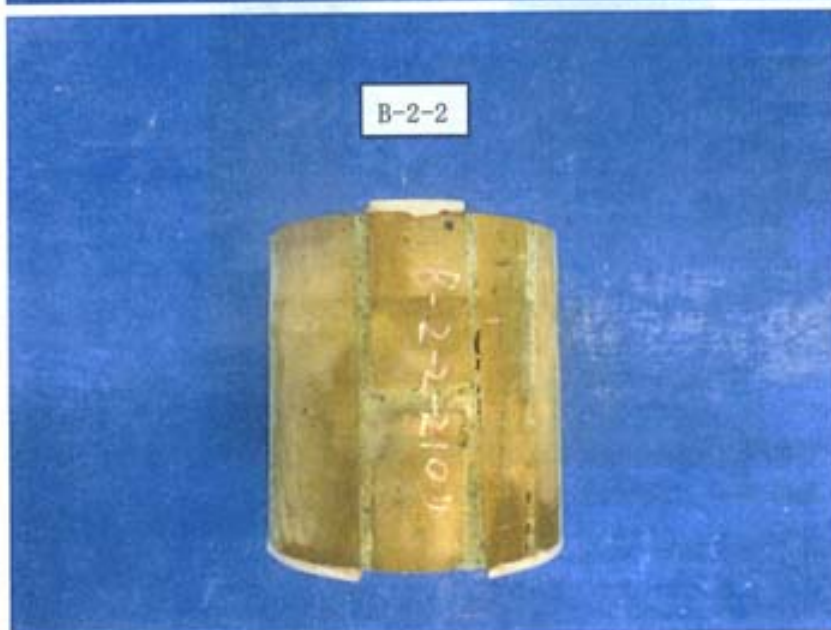
写真-37 整形・キャッピング後の供試体 [れんがコア(要素)] (目地モルタルのせん断強度 試験用)
