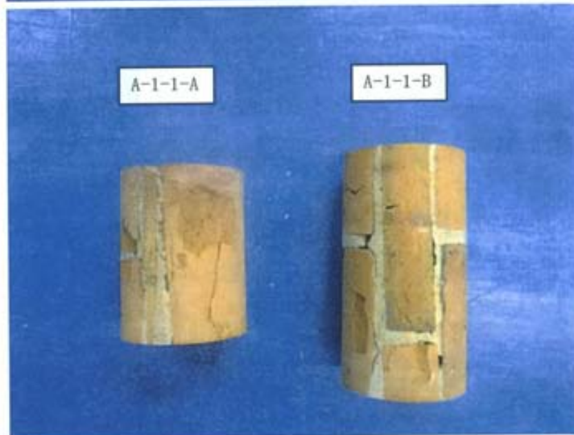
写真-41 圧縮強度試験後の破壊状況 (裏面) [A-1-1-A 及び A-1-1-B]
