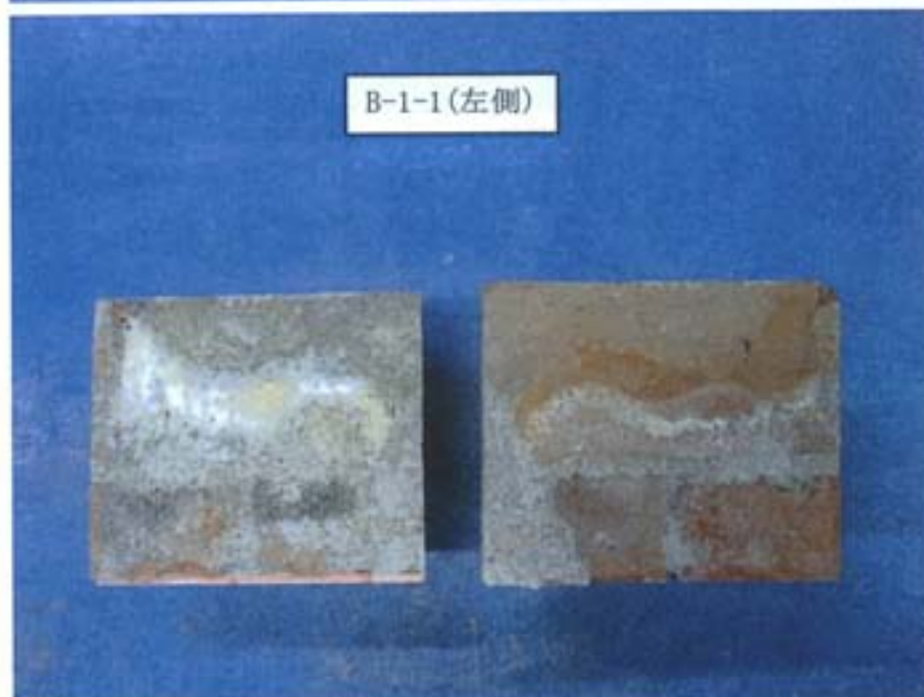
写真-73 目地モルタルの破壊状況 (写真-72 左側) [B-1-1]
