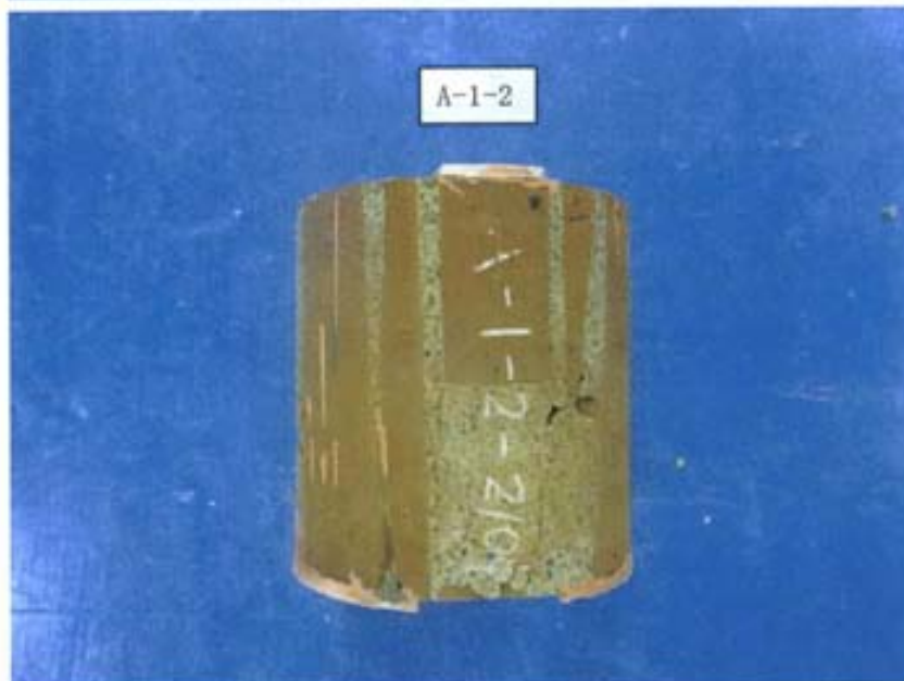
写真-24 整形・キャッピング後の供試体 [れんがコア(要素)] (目地モルタルのせん断強度 試験用)
