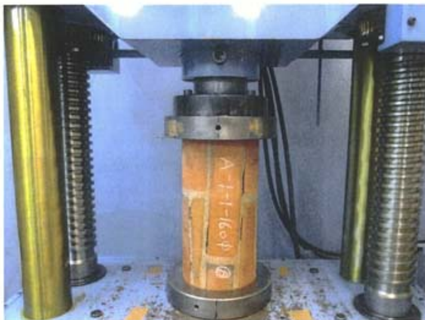
写真-22 圧縮強度試験状況 [れんがコア (要素) A-1-1-B]
