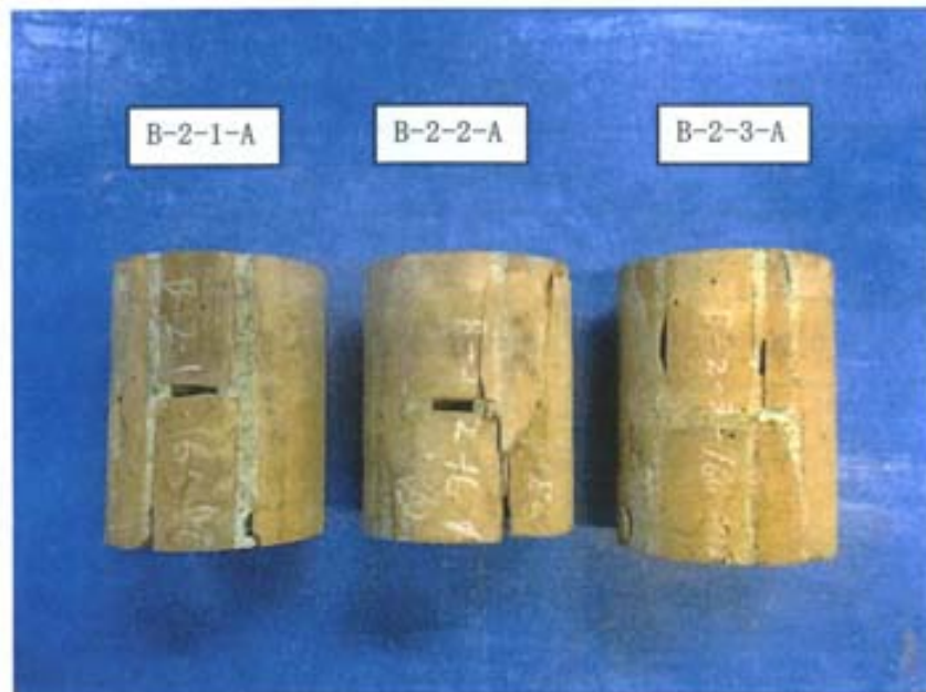
写真-47 圧縮強度試験後の破壊状況 [B-2-1-A, B-2-2-A 及び B-2-3-A]
