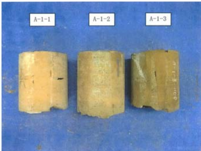
写真-8 供試体の外観 [れんがコア(要素)] (目地モルタルのせん断強度 試験用)
