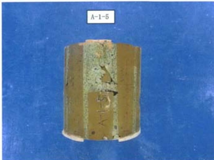
写真-27 整形・キャッピング後の供試体 [れんがコア(要素)] (目地モルタルのせん断強度 試験用)
