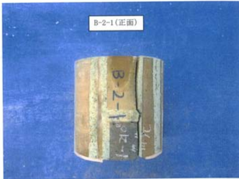
写真-87 目地モルタルの破壊状況 (正面) [B-2-1]
