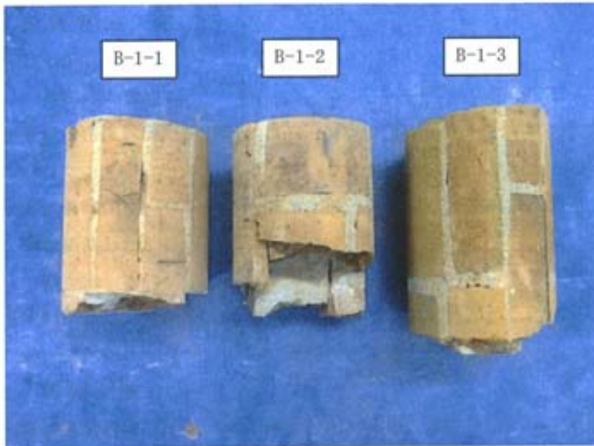
写真-11 供試体の外観 [れんがコア(要素)] (目地モルタルのせん断強度 試験用)
