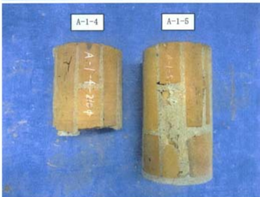
写真-9 供試体の外観 [れんがコア(要素)] (目地モルタルのせん断強度 試験用)
