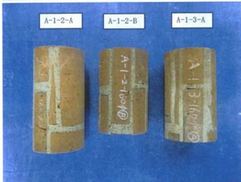
写真-17 整形・研磨後の供試体 [れんがコア(要素)] (圧縮強度試験用)
