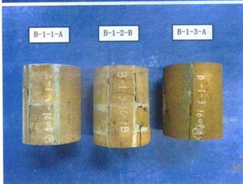
写真-45 圧縮強度試験後の破壊状況 [B-1-1-A, B-1-2-B 及び B-1-3-A]
