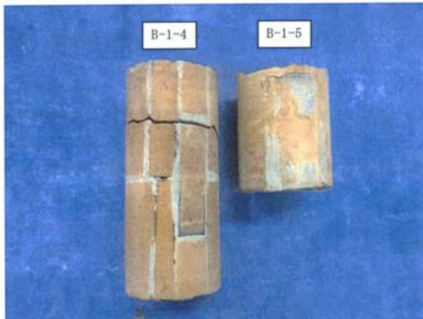
写真-12 供試体の外観 [れんがコア(要素)] (目地モルタルのせん断強度 試験用)
