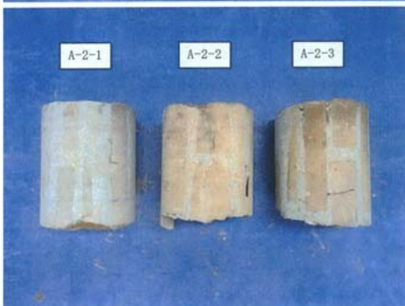
写真-10 供試体の外観 [れんがコア(要素)] (目地モルタルのせん断強度 試験用)
