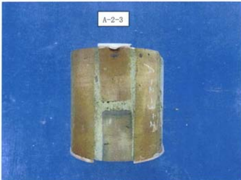
写真-30 整形・キャッピング後の供試体 [れんがコア(要素)] (目地モルタルのせん断強度 試験用)
