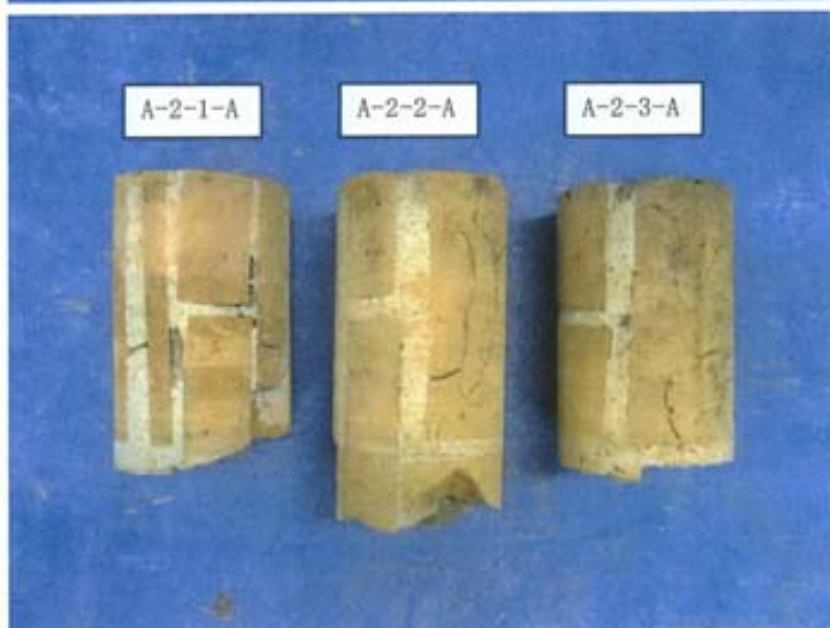
写真-4 供試体の外観 [れんがコア(要素)] (圧縮強度試験用)
