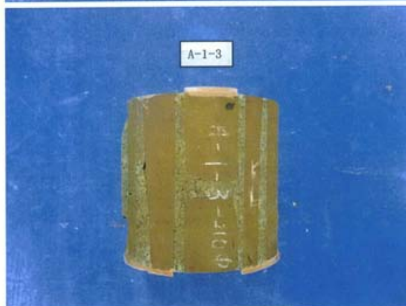
写真-25 整形・キャッピング後の供試体 [れんがコア(要素)] (目地モルタルのせん断強度 試験用)
