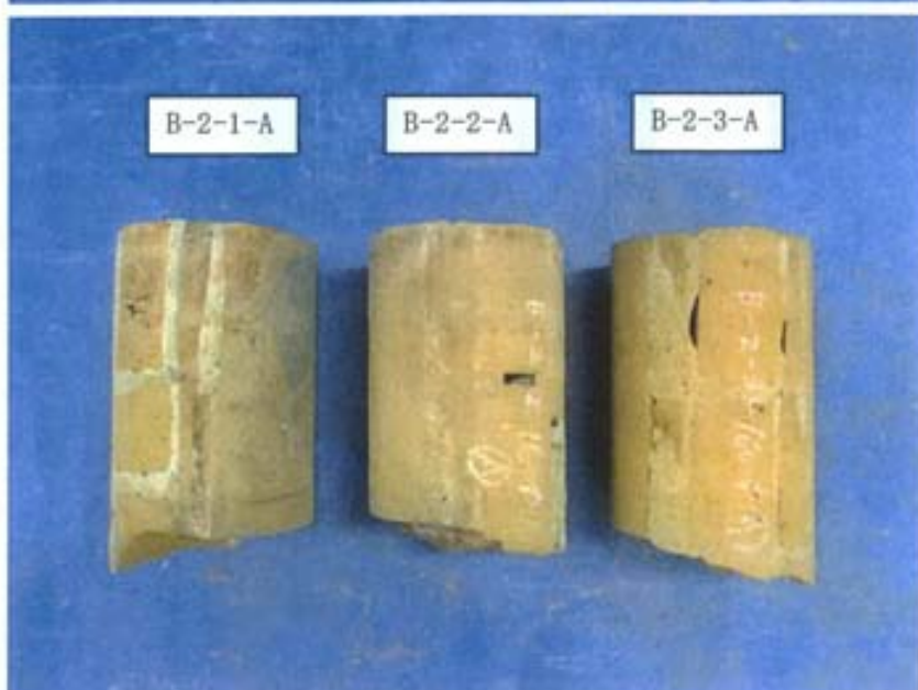
写真-7 供試体の外観 [れんがコア(要素)] (圧縮強度試験用)
