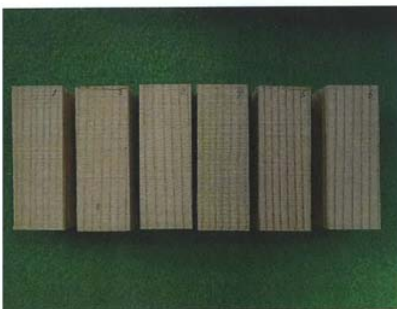
写真-6 縦圧縮試験用試験体（試験後）
