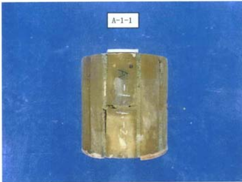
写真-23 整形・キャッピング後の供試体 [れんがコア(要素)] (目地モルタルのせん断強度 試験用)
