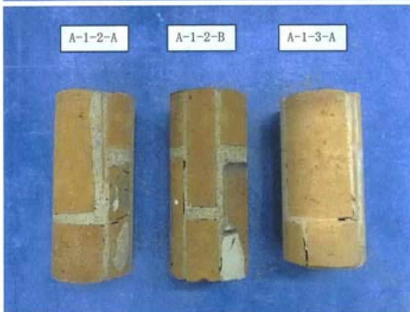
写真-3 供試体の外観 [れんがコア(要素)] (圧縮強度試験用)
