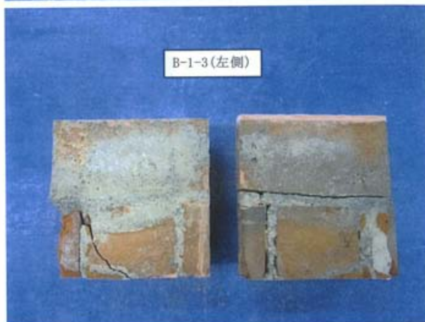
写真-79 目地モルタルの破壊状況 (写真-78 左側) [B-1-3]
