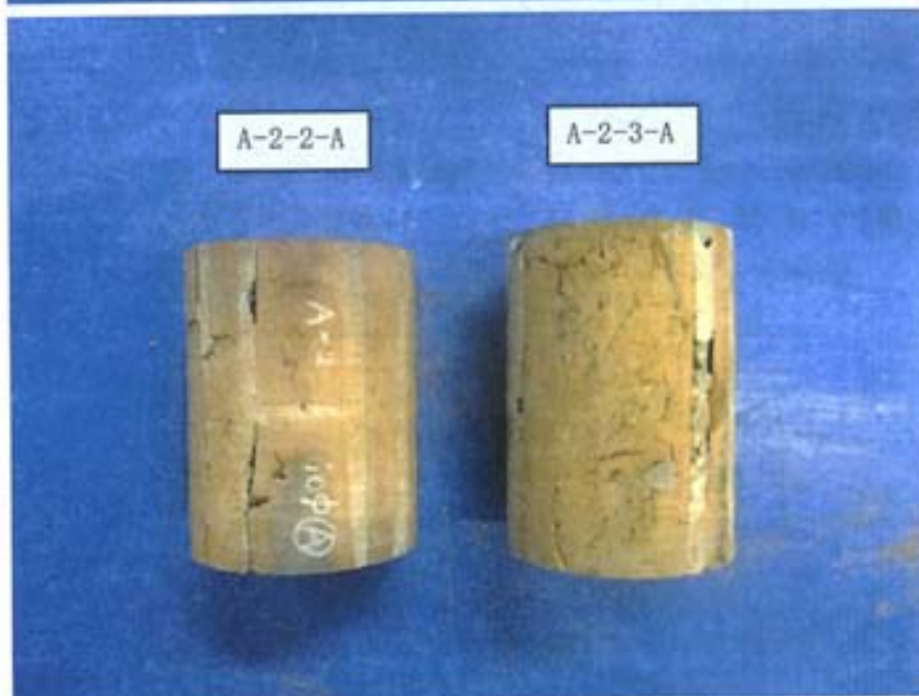
写真-44 圧縮強度試験後の破壊状況 [A-2-2-A 及び A-2-3-A]
