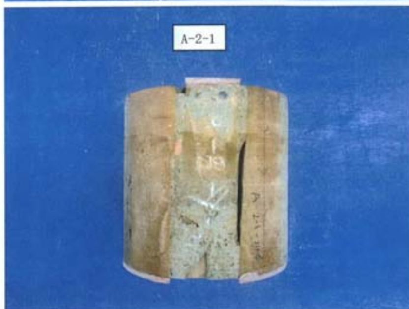
写真-28 整形・キャッピング後の供試体 [れんがコア(要素)] (目地モルタルのせん断強度 試験用)
