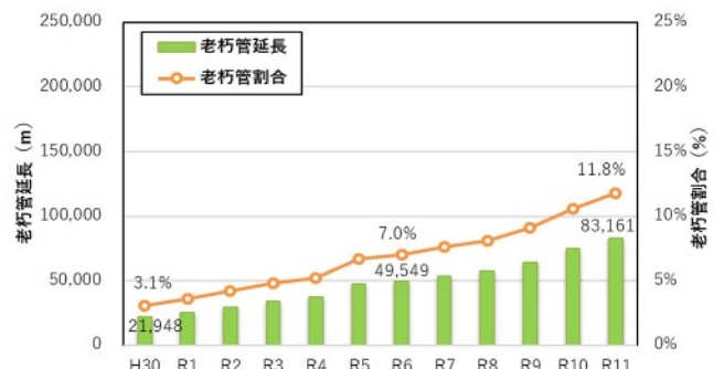
老朽管延長と管路全体に対する老朽管割合の見通し（公共下水道）
