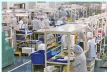
◀ 工場内の作業風景。工場では、購入した部材から部品を組み立て、モーターに組み上げる工程を行っている。
