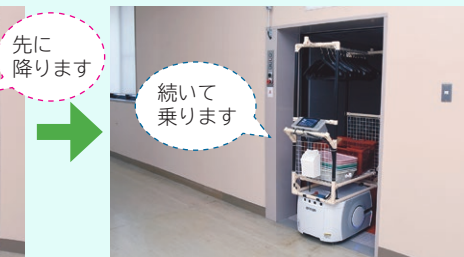
▲リフトの昇降も自動で行う。先に乗っている自動搬送機が降りるのを待ってから、次の搬送機が乗ることも可能。
