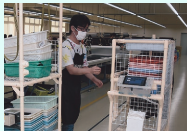
▲自動搬送機が人に代わって別工程に荷物を運ぶことで作業効率が向上
