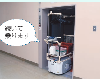
▲リフトの昇降も自動で行う。先に乗っている自動搬送機が降りるのを待ってから、次の搬送機が乗ることも可能。
