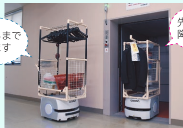
▲リフトの昇降も自動で行う。先に乗っている自動搬送機が降りるのを待ってから、次の搬送機が乗ることも可能。
