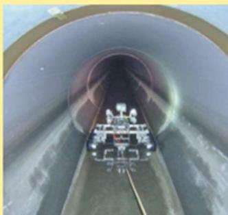
下水管の点検ロボット。
