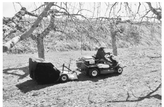
乗用草刈機で牽引して使用する落葉収集機
