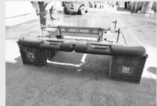
有機栽培の現場で活用される水田乗用草刈機(上)、自動除草ロボット(下)
